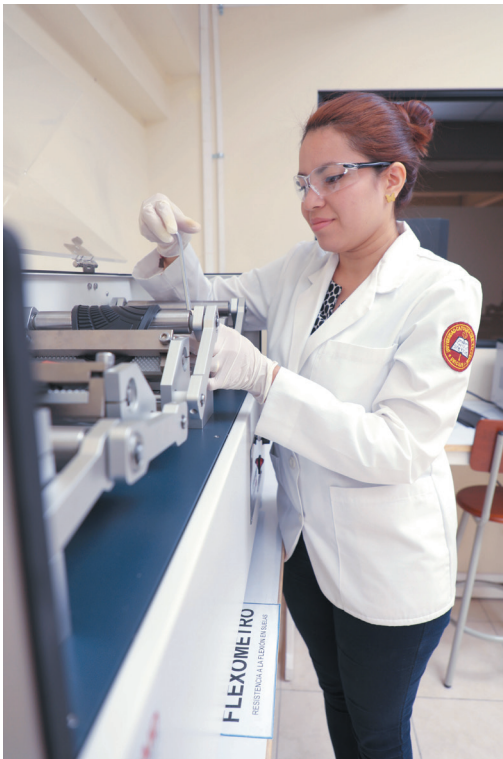
Figura 4. Ensayo de flexión en suela.
